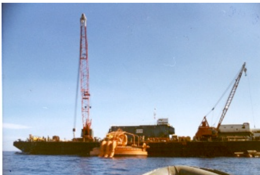
Bergen "CB-1" installerer en SBM CALM lastebøye
