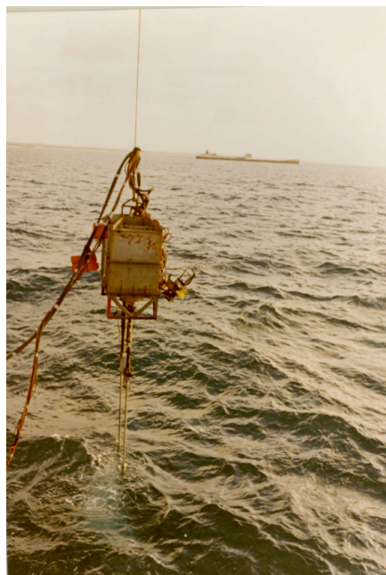
Drillanker for å feste rørledningene til bunnen
